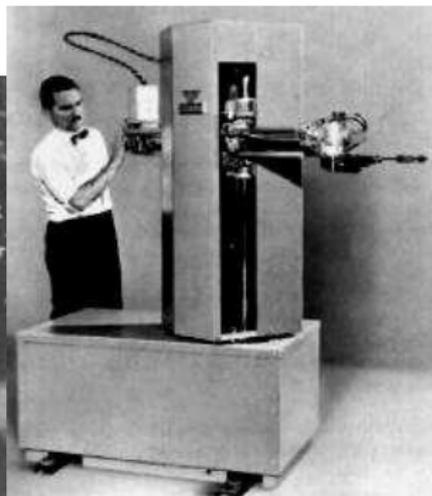
**1960-1961 гг.** Первые промышленные роботы-манипуляторы, разработанные Unimation, внедряются на заводах General Motors. Программа на магнитном барабане, грузоподъемность 40 кг. Промышленный робот "Versatran".
